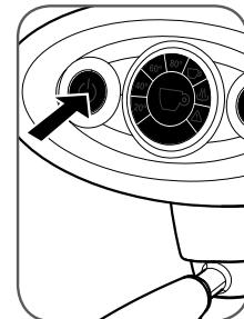
Houd de knop
