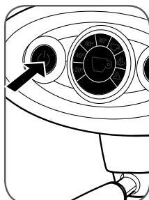
Schakel het apparaat uit en trek de stekker uit het stopcontact.
