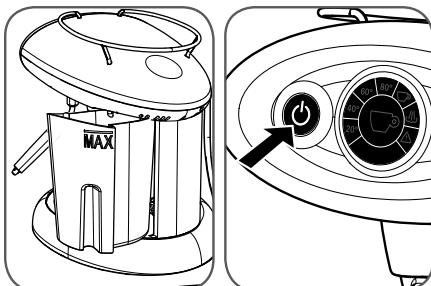
Tænd maskinen ved at holde hovedkontakten trykket nede, indtil kontrollampen tændes.
