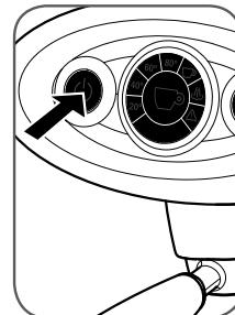
Sluk maskinen ved at holde hovedkontakten trykket nede, indtil kontrollampen på frontpanelet slukkes. Det frarådes at fjerne stikket fra stikkontakten, mens maskinen er tændt.
