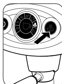
Tryk på knappen for damp ☕. Dampsymbolet på den runde skive tændes for at angive, at maskinen er ved at gøre sig parat til brug af dampfunktionen.
