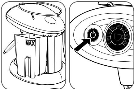
Druk op de knop
